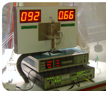
Измерване на критична температура и съпротивление на свръхпроводник в Грац, Австрия. Фотография: SRD
